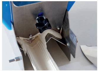
An der rückseitigen Öffnung kann die Spachtelauftragsmenge auf den Rigips Levelline reguliert werden. Zufuhrmenge optimal einstellen, los geht's!
