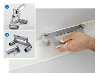
Der Rigips Einseitenroller mit Gewindestiel 1 und der Einseitenroller nach Entfernung 2 des Metallspunds für die direkte "Handverarbeitung". Der abgerundete Haltegriff ist ergonomisch geformt und ermöglicht so eine angenehme Handhabung.
