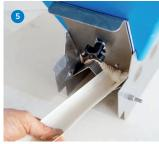
Damit der Rigips Levelline leicht in den Zufuhrbehälter einzuführen ist, kann mit einer Stellschraube die Öffnungsgröße reguliert werden. Der Rigips Levelline wird nun durch die Öffnung eingeschoben und über eine Führungsschiene gelangt er zur rückseitigen Öffnung.
