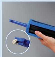
Halten Sie die Rigitone Fix Pistole etwas hoch und betätigen Sie solange den Abzug bis keine Luft mehr in der Kartusche vorhanden ist und das VARIO Fugenspachtelmaterial aus der Fugendüse ohne Unterbrechung heraustritt.
