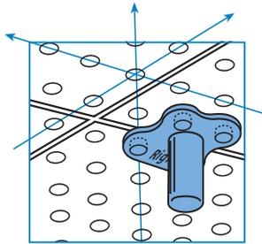
Die Fugen **satt und vollständig** ausfüllen, so dass sich ein Wulst auf der Rückseite der Platte bildet.
