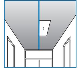
Die nachfolgenden Platten werden sternförmig von der Raummitte ausgehend montiert. Dabei muss zudem auf eine einheitliche Verlegerichtung geachtet werden (siehe stirnseitige Markierung und seitliche Kantenbeschriftung).
