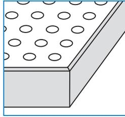
Die einzelnen Platten werden ausgerichtet mit Hilfe der zum Lochbild gehörenden Montagehilfe und nach optischer Kontrolle über die Lochreihen (gerade oder diagonal). Nach der Verschraubung der Platten ist die Montage abgeschlossen und der nächste Verarbeitungsschritt kann erfolgen.
